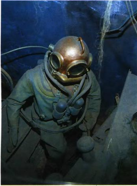
Скафандр конструкции А. Зибе используется уже более 150 лет.
