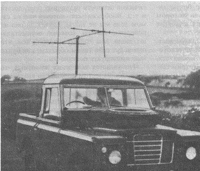
Рис. 24.14. Радиоприемное устройство, смонтированное на крыше лендровера (вездехода), которое используется для отслеживания серебристых чаек на острове Уолни в Камбрии (Великобритания). (Фотография Richard Sibly.)
